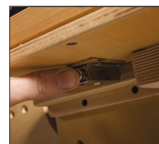
Снимается столешница без отвертки
